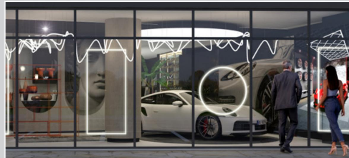
Linea luminosa 360° in materiale silicico morbido e sinuoso, luce uniforme senza la percezione di zone d'ombra, adatta ad ambienti sia interni che esterni. La lunghezza è assemblabile a piacere collegando i moduli uno con l'altro. Colore luce 3000 K - Ø 25 mm
